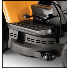
Zwei-Messer-Mähwerk für 84 cm Schnittbreite.
